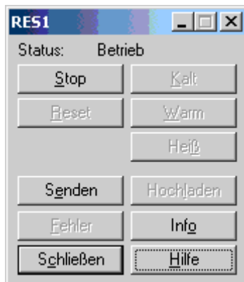
Abbildung 20: Funktionen des Kontrolldialogs der ausgewählten Ressource im Zustand "RUN".
