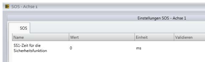
Abbildung 25: P213.005: SS1-Zeit für die Sicherheitsfunktion „SOS“
