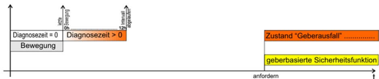
Abbildung 4: „Geberüberwachung bei SINCOS-Geber mit Asynchronmotor“: Diagnosezeit von 12 h abgelaufen -> Erneute Anforderung Sicherheitsfunktion
