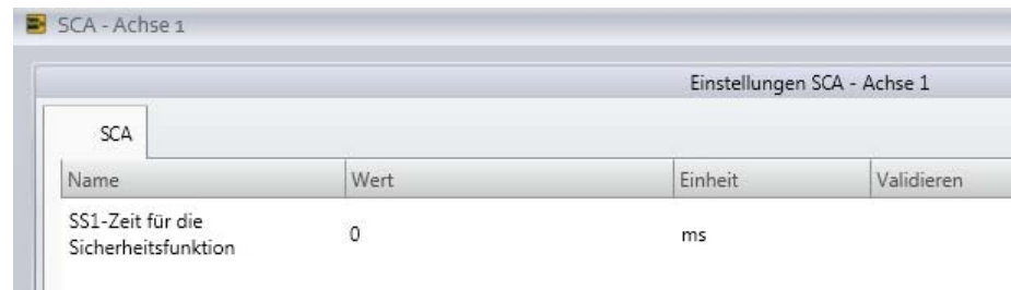
Abbildung 44: P222.005: SS1-Zeit für die Sicherheitsfunktion „SCA“
