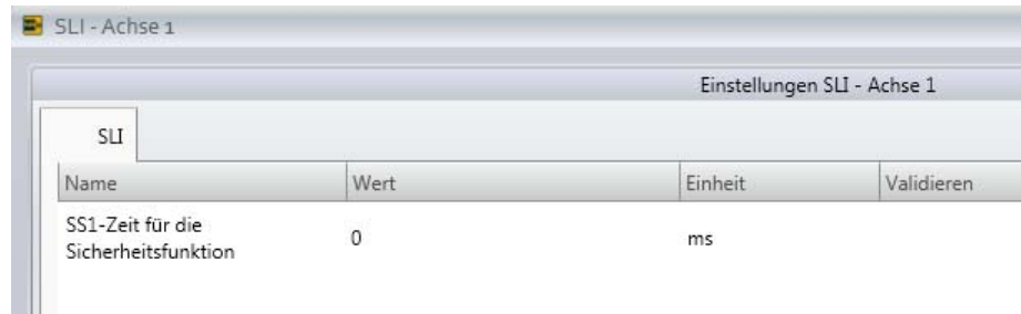
Abbildung 36: P216.005: SS1-Zeit für die Sicherheitsfunktion „SLI“
