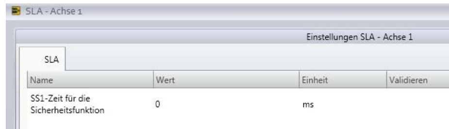
Abbildung 40: P218.005: SS1-Zeit für die Sicherheitsfunktion „SLA“
