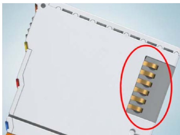
Abbildung 6: Federkontakte der I/O-Komponenten
