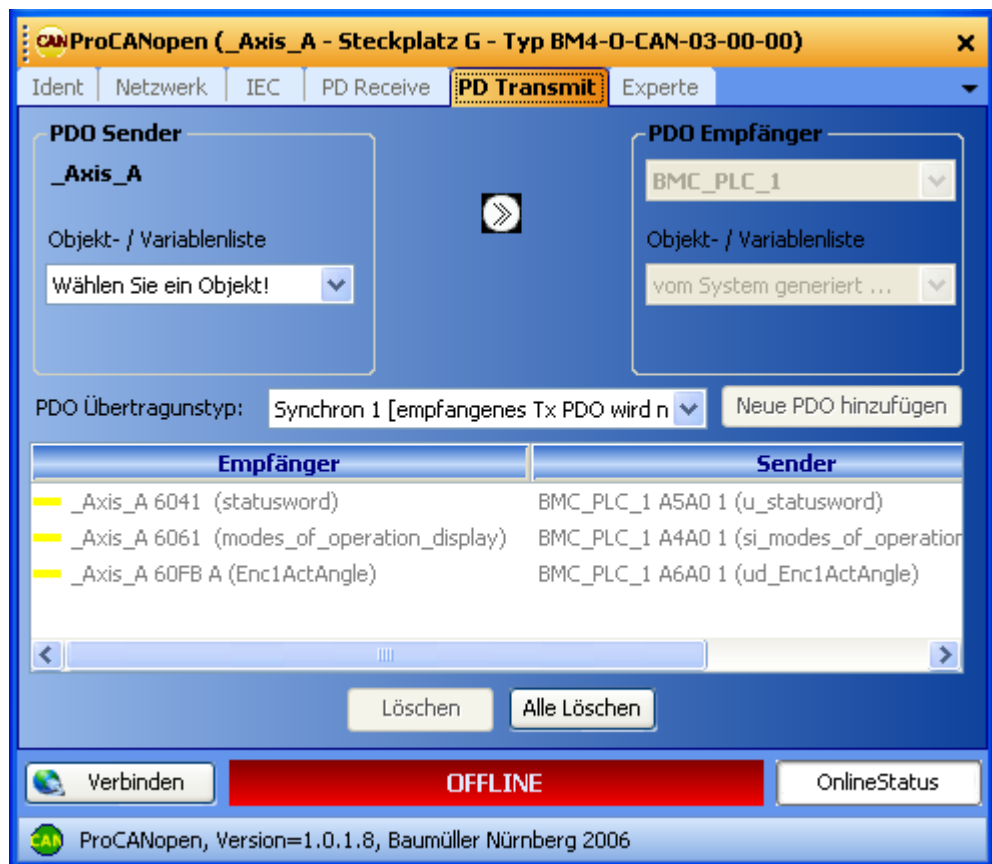
Abbildung 44: ProCANopen - Motion Control CANopen-Slave Kommunikationskonfiguration Register „PD Transmit“ mit Default Motion Control Konfiguration
