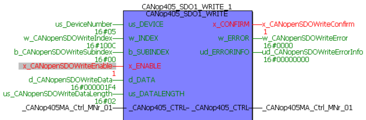
Abbildung 112: Node Guarding Zeit auf CANopen-Slave einstellen
