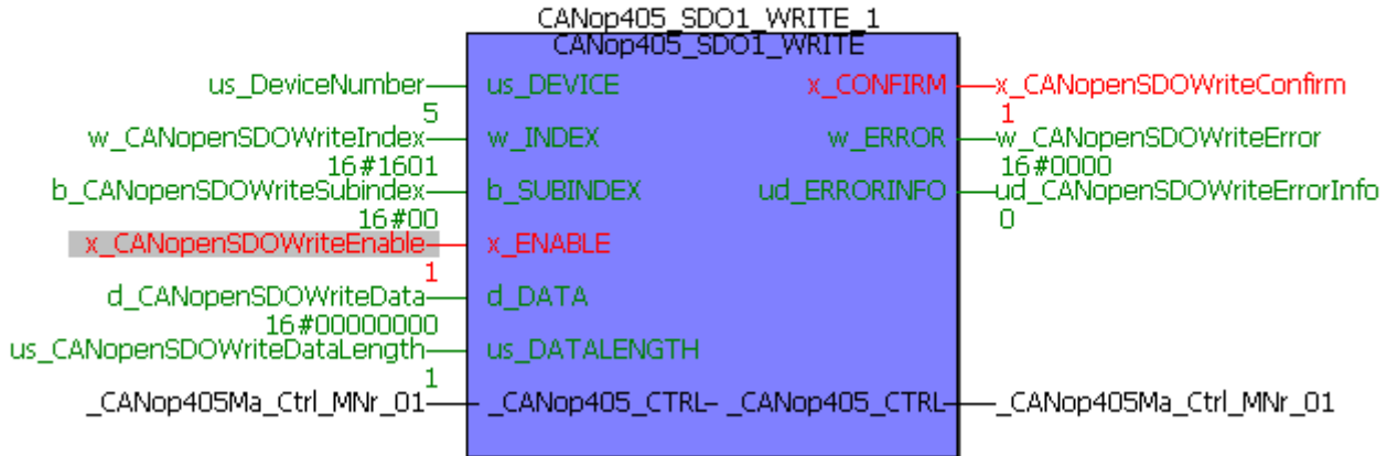
Abbildung 89: Mapping des zweiten Empfangs PDO löschen
