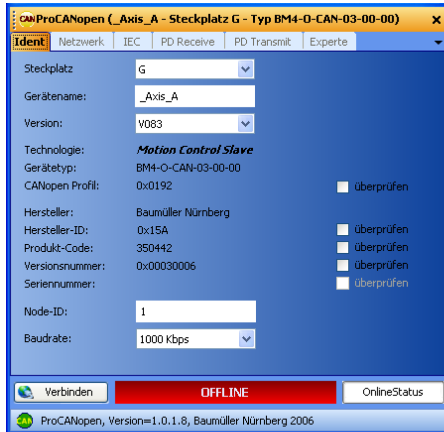
Abbildung 39: ProCANopen - CANopen-Slave Kommunikationskonfiguration Register Ident
