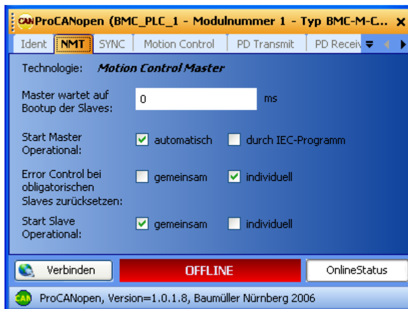
Abbildung 48: ProCANopen - CANopen-Master Kommunikationskonfiguration Register NMT
