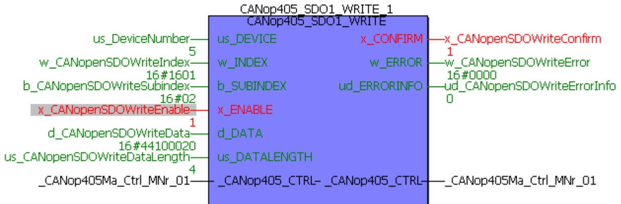
Abbildung 91: Zweites gemappte Objekt des zweiten Empfangs PDO eintragen
