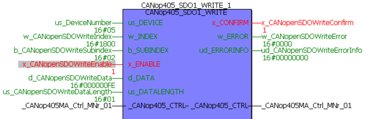
Abbildung 103: Konfiguration des ersten Sende PDO des CANopen-Slave schreiben - Subindex 2
