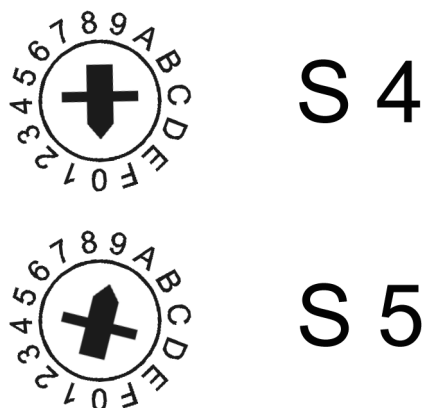
Abbildung 11: Beispiel: Einstellen der Ethernet-Adresse 192.168.1.10 (Drehschalter S4 auf 0, Drehschalter S5 auf 9)
