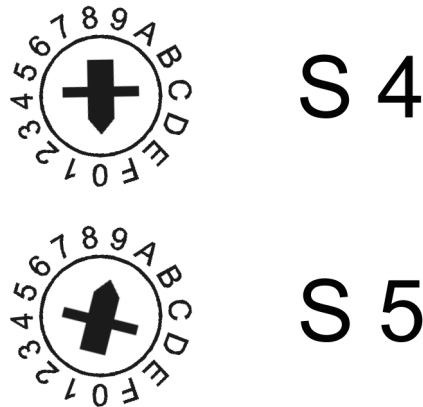
Abbildung 16: Beispiel: Einstellen der Ethernet-Adresse 192.168.1.10 (Drehschalter S4 auf 0, Drehschalter S5 auf 9)
