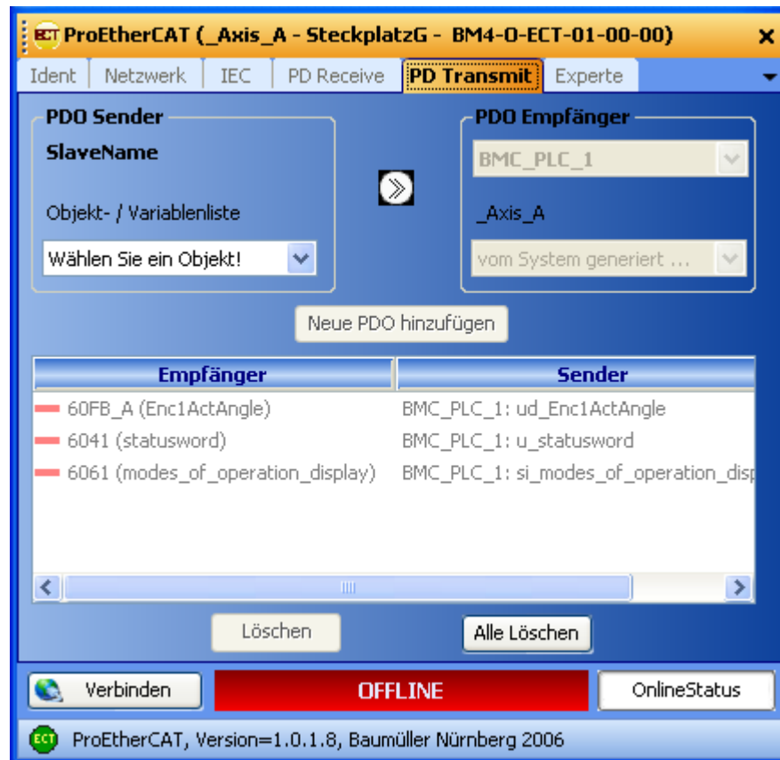
Abbildung 41: ProEtherCAT - Motion Control EtherCAT-Slave Kommunikationskonfiguration Register „PD Transmit“ mit Default Motion Control Konfiguration
