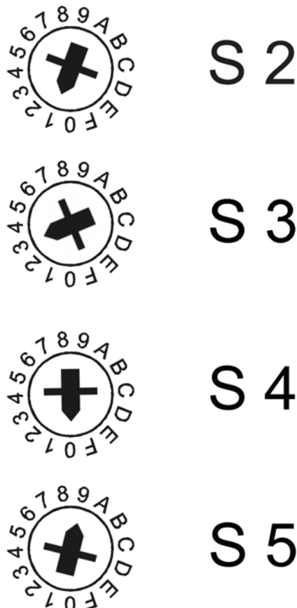
Abbildung 28: Beispiel: Einstellen der Ethernet-Adresse 192.168.20.10 (Drehschalter S2 auf 1, Drehschalter S3 auf 3, Drehschalter S4 auf 0, Drehschalter S5 auf 9)
