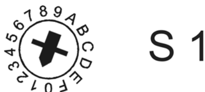
Abbildung 16: Beispiel: Einstellen der Modul-Adresse 1 (Drehschalter S1 auf 1)
