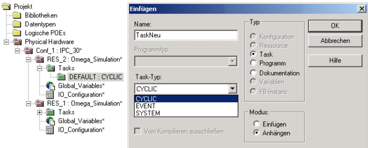
Abbildung 124: Einfügen einer CYCLIC-Task
