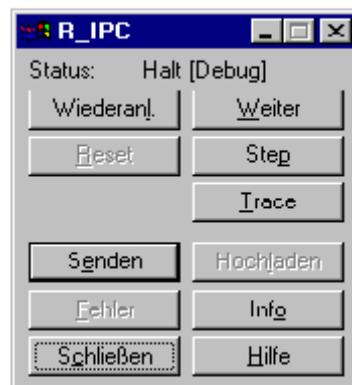
Abbildung 140: Kontrolldialog bei gesetztem Breakpoint
