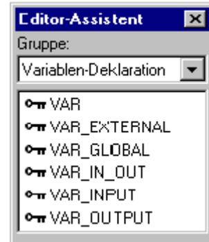
Abbildung 61: Editor-Assistent in einem Variablen-Arbeitsblatt
