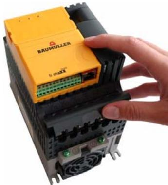
Abbildung 11: Abdeckung für Motorklemmen abnehmen
