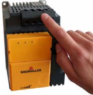
Abbildung 10: Abdeckung für Netzanschlussklemmen abnehmen
