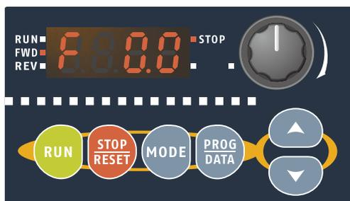
Wenn Netzspannung eingeschaltet ist, wird „F0.0“ und die LED „STOP“ angezeigt und „FWD“ sollte aufleuchten
