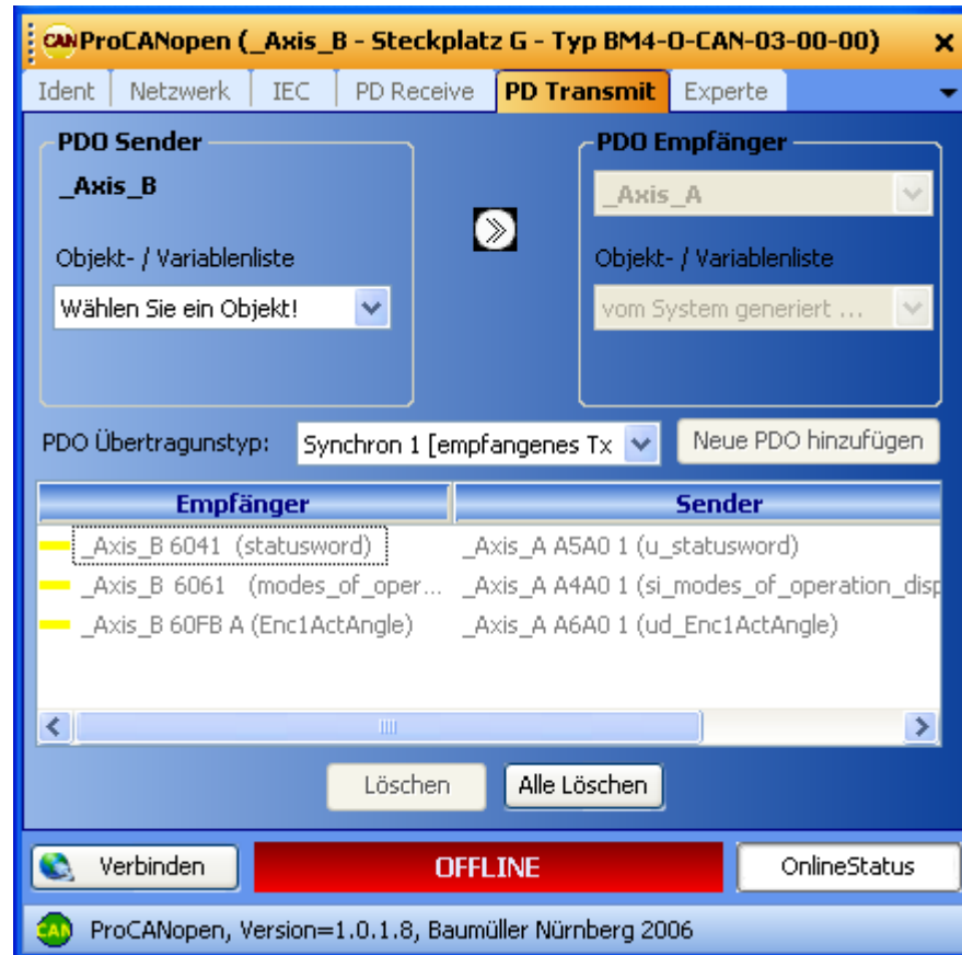
Abbildung 39: ProCANopen - Motion Control CANopen-Slave Kommunikationskonfiguration Register „PD Transmit“ mit Default Motion Control Konfiguration
