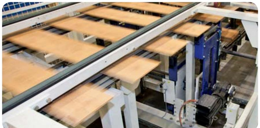
Bei der Produktion von Fußbodendielen sind Dynamik und Synchronlauf gefordert. Permanenterregte Servomotoren von SEW Eurodrive erfüllen diese Anforderungen.
