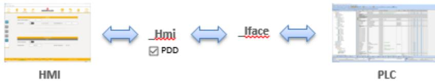
Hier befindet sich die Schnittstelle vom und zum HMI. Alle Daten, die entweder vom HMI kommen, oder aber auch an das HMI gehen, werden hier übergeben. Damit kann man vor dem Empfangen, bzw. Senden die Daten nochmals validieren und auf ihre Gültigkeit hin prüfen.
